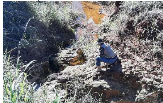
Figura 45 – Voçoroca ao longo da BR-479. Presença do lençol freático atingindo o substrato rochoso saprolitizado.
