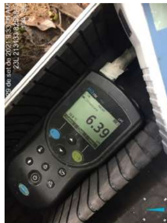
Figura 65 – Medidor multiparâmetro para análises in loco .
