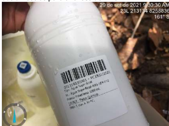
Figura 66 – Frasco de polietileno para conservação das amostras para análises de DBO.
