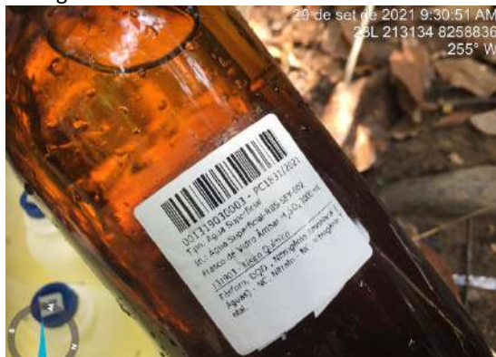
Figura 68 – Frasco de vidro âmbar para conservação das amostras para análises de Fósforo, DQO, Nitrato, Nitrogênio Total e Nitrogênio Amoniacal.
